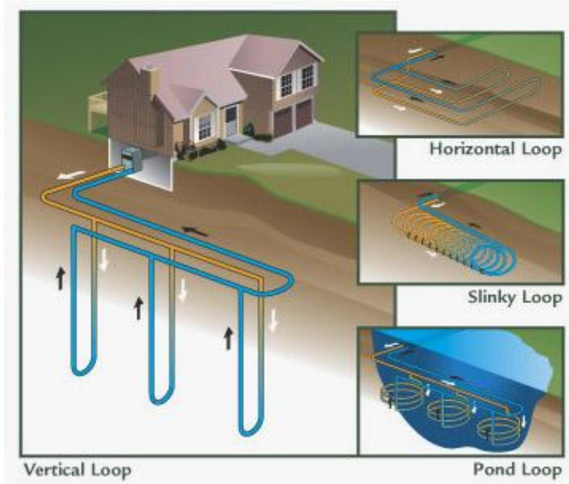
Riqualificare gli impianti – I sistemi a pompe di calore geotermiche
